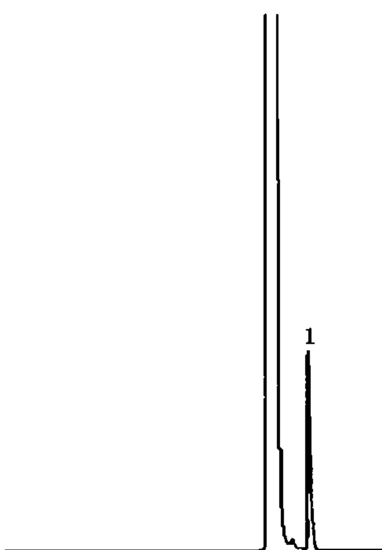
图 1 40%乙烯利水剂中 1,2-二氯乙烷测定的气相色谱图
